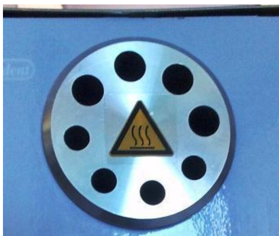
Figura 4. Cilindro de calentamiento de las jeringas
